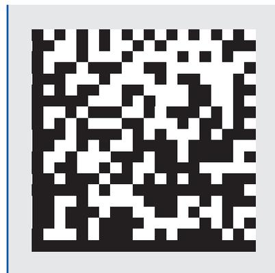
Die GS1 DataMatrix besteht aus einem L-förmigen Suchmuster. In der rechten oberen Ecke befindet sich immer ein weißes Quadrat als Zeichen für ECC 200.
